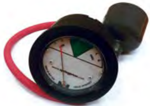
Vacutest Instrumento analógico para controlar la aspiración del muletón. Para una correcta utilización del muletón, la aguja debe estar siempre en la zona verde.
